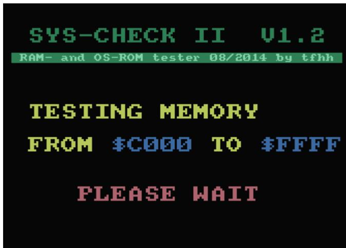
Um diesen Speicher zu testen, wird die Bildausgabe abgeschaltet, da es sonst zu Grafikstörungen kommen würde. Damit der Anwender sieht, daß der Test noch arbeitet, werden ein paar bunte Muster gezeigt, wie man das von Entpackern kennt:
