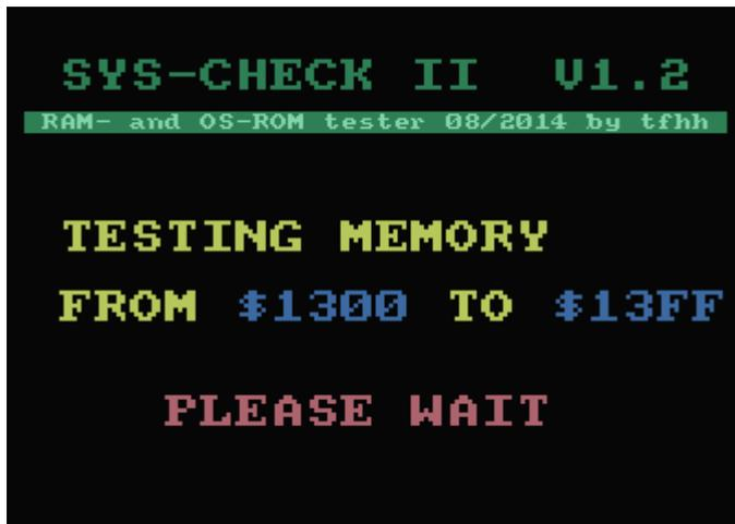
Der Speicher wird von \$0800 bis \$BFFF in Pages geprüft. Anschließend erfolgt der Test der oberen 16 KByte (das ist der Bereich, der „unter dem Betriebssystem“ liegt).
