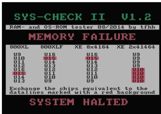
In diesem Beispiel ist der DRAM-Chip, der das Datenbit 6 (also 01000000) beinhaltet, fehlerhaft. Sys-Check zeigt dieses nun so an, daß sofort klar ist, welcher DRAM IC auf der Hauptplatine ausgetauscht werden muß. Die Chipnummer (Uxx) stimmt mit der jeweiligen Platine überein, ebenso die Position des Bausteines – jeweils von oben nach unten bei normaler Aufsicht auf die Rechner-Hauptplatine.
