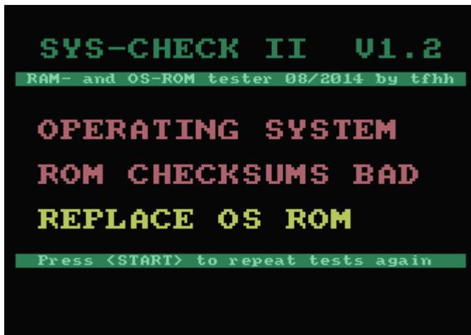
Die Prüfsummen stimmen nicht – möglicherweise ist das OS-ROM (oder EPROM) defekt, nicht eingesteckt oder es ist eine gepatchte OS Version drauf, wo der Selbsttest deaktiviert wurde und die Prüfsummen nicht korrekt angepaßt worden sind. Gute Patches (wie Hias' Highspeed SIO Patch) sollten das allerdings machen.
