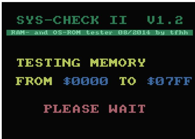
Die ersten 2 KByte des Speichers werden in einem Rutsch getestet.
