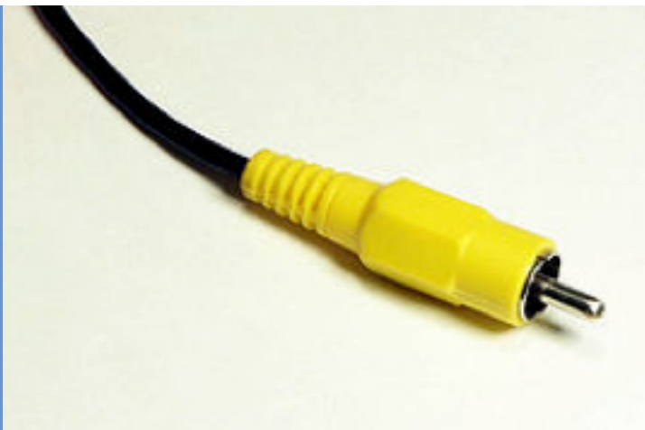
Fig. 5 Il connettore RCA, usato per la trasmissione del video composito.
