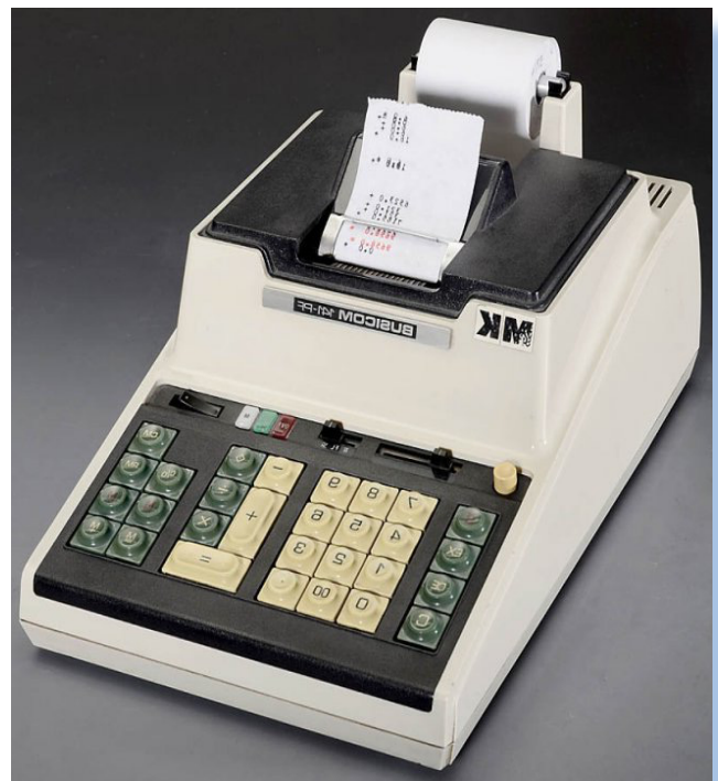
Basicom 141 P - la prima serie di macchine calcolatrici ad usare il mp 4004.
