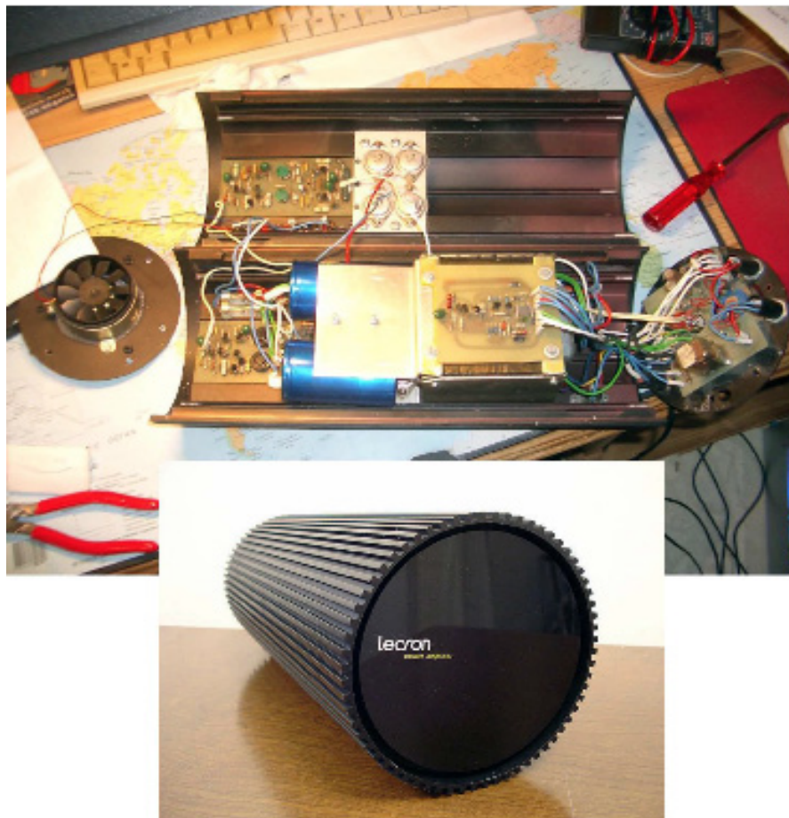
Fig. 9 - L'amplificatore Lecson aperto, mostra come i componenti interni siano ingegnerizzati per smaltire il calore in maniera ottimale.
