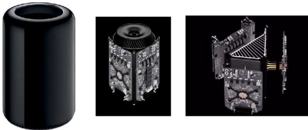
Fig. 10 - Forma e funzionalità secondo Ive, il Mac Pro dissipa il calore aiutato dalla ventola superiore che espelle l'aria calda.
