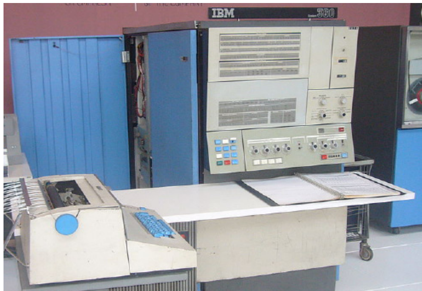
Fig. 2 Un IBM/360 in esposizione. Sulla destra due unità a nastro e immediatamente a sinistra della console si intravedono i cabinet delle unità a disco. Il modello è probabilmente degli anni 65-66.
